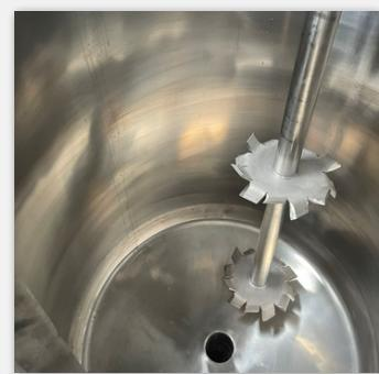
O TRITURADOR DE 200 LITROS DA LUPAFRIO É ESSENCIAL NO PREPARO DA MISTURA DE CALDA DE SORVETE, PICOLÉS E TRITURAÇÃO DE BARRAS DE FRUTAS E AÇAÍ. ASSEGURA A QUALIDADE DO PRODUTO FINAL COM UM EQUIPAMENTO 100% SANITÁRIO.
